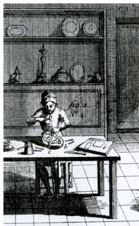
Un ciseleur-doreur maniant le ciselet et le marteau. A côté de lui, le coussin avec les feuilles d'argent. (Encyclopédie, Planches, T. I, « Argenteur », pl. I, fig. 1, n°2).
