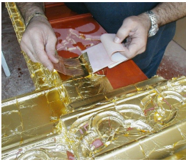
La pose des feuilles d'or sur un support en bois recouvert de Bol d'Arménie.
